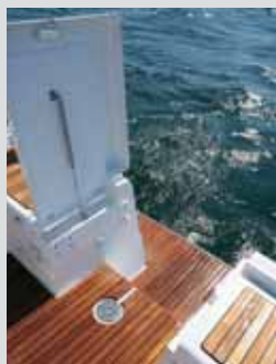
Banc barreur pivotant avec vérin à gaz en inox • Swivelling helmsman's bench • Seduta timoniere girevole • Asiento skipper pivotante • Schwenkbare Rudergängerbank
